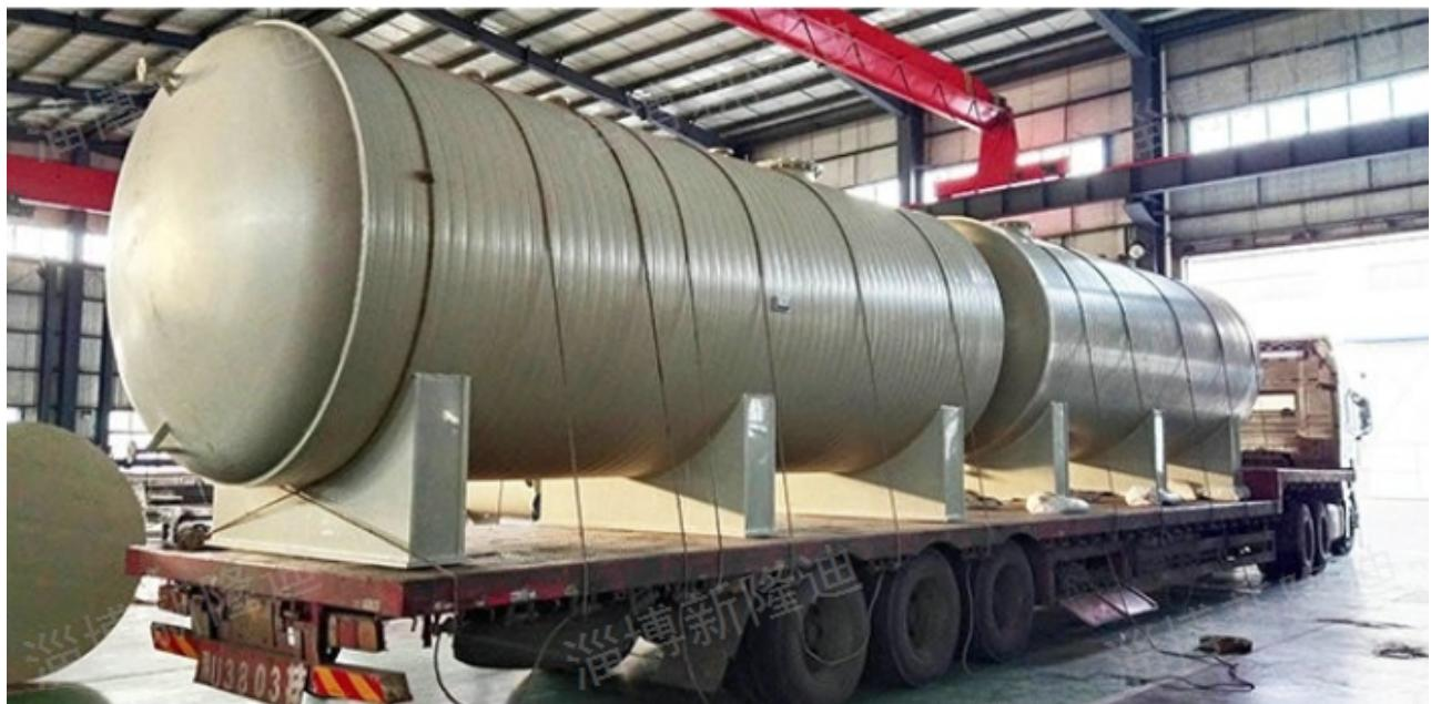
含有易燃、腐蚀性、有毒或窒息介质的储罐应更换、中和、消毒、清洗等PPH储罐处理后进行分析和修复。分析结果应符合相关规范，并标定刻度。如有易燃介质，禁止用空气更换。罐内作业需要罐内作业许可证。取样分析进入罐内作业0分钟，含氧量在18-23%(体积比)之间。进入储罐时，应佩戴有毒和腐蚀性残留物的个人防护装备。需要搭建脚手架和升降装置时，需要牢固可靠。严禁在作业内外抛掷材料和工具，以确保作业安全。PPH储罐内的照明应使用电压不超过24的防爆灯。储罐需要动火时，需要申请动火作业证书。罐区作业需设监护人，并采取可靠的联系措施。检查完成后，检查人员和监护人员应共同检查罐内外。确认后，监护人应在PH储罐内签署作业证书，然后堵塞所有人孔。试压后排水时，应防止抽真空。PPH储罐的维护方法应基于产品的性能和注意事项。河北PPH缠绕储罐定制淄博新隆迪环保科技有限公司全心全意的为广大消费者服务！
